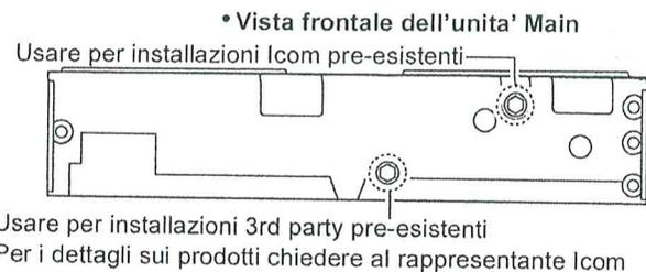
6. Connettere nuovamente il cavo al connettore anteriore e reinstallare il pannello frontale.
