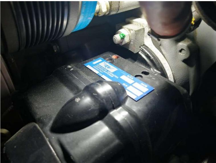
FIG.6 B; Il magnete destro di ACMM con lo spessore in alluminio di colore più chiaro, decisamente più sottile di quello del sinistro
