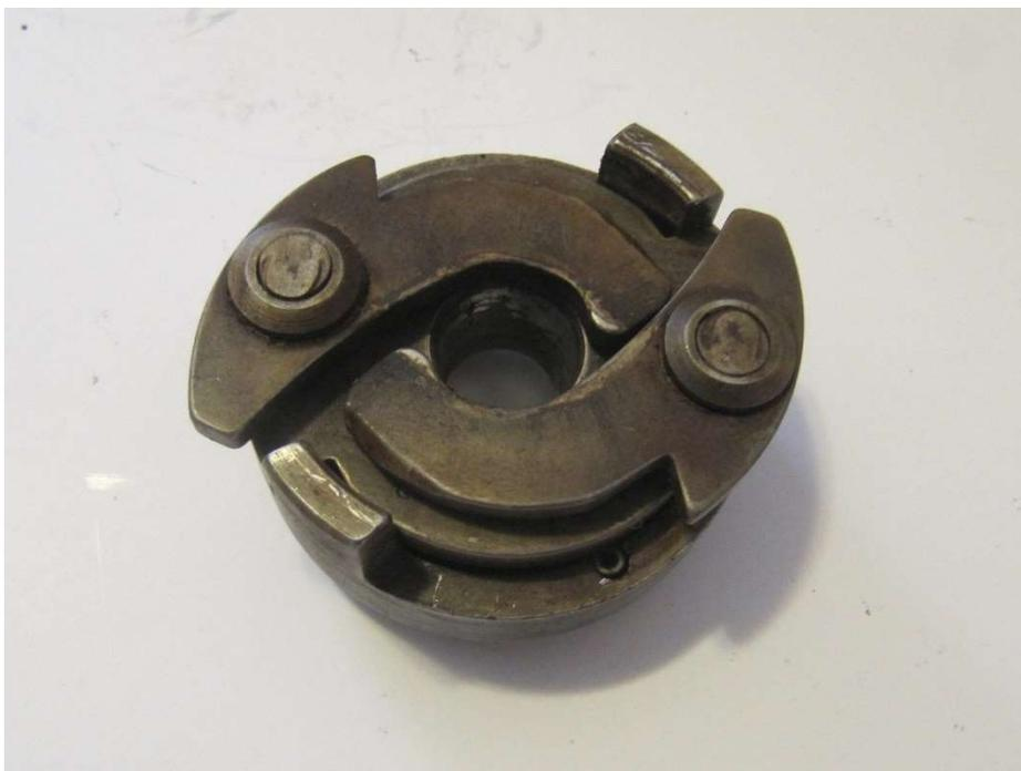
Fig. 5B; il meccanismo centrifugo dell "impulse coupling"
