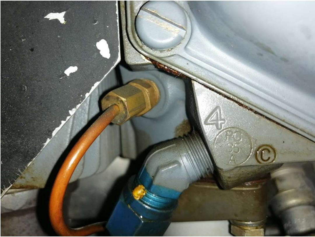
FIG 7 A; Iniezione del cicchetto nel cilindro No. 4 di ACMM. Notare che l'iniezione sull'impianto di ACMM avviene solo sui cilindri 1-2-4, il cilindro numero 3 (posteriore destro) non ha iniezione di cicchetto. Il raccordo blu in primo piano è il ritorno al carter dell'olio che lubrifica le punterie
