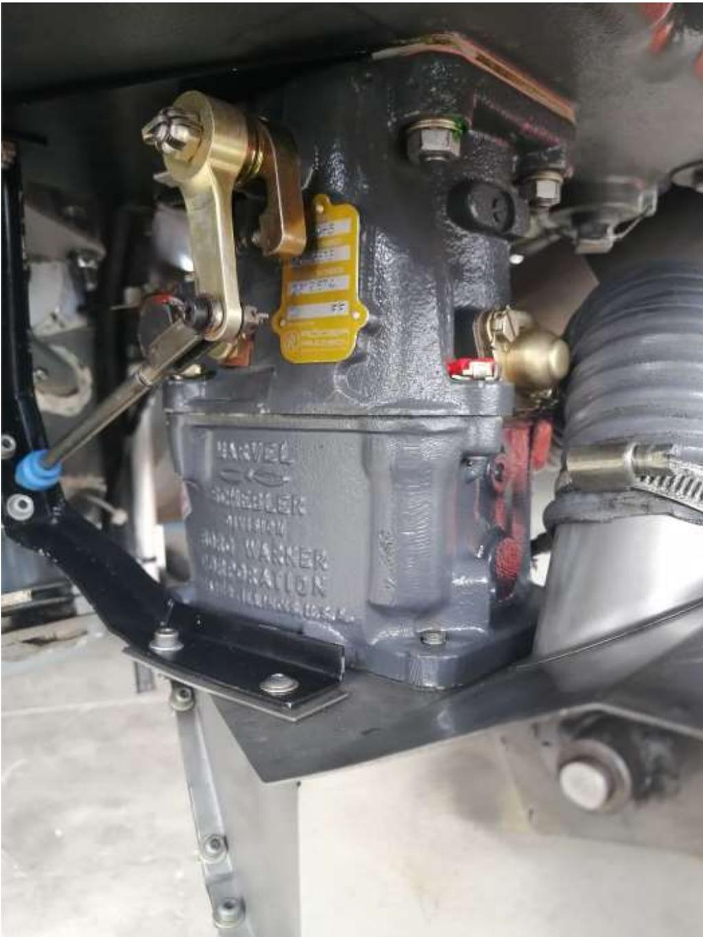
FIG.8; Carburatore di I-BOLK, Marwel Schebler 4-5 con pompa di recupero interna
