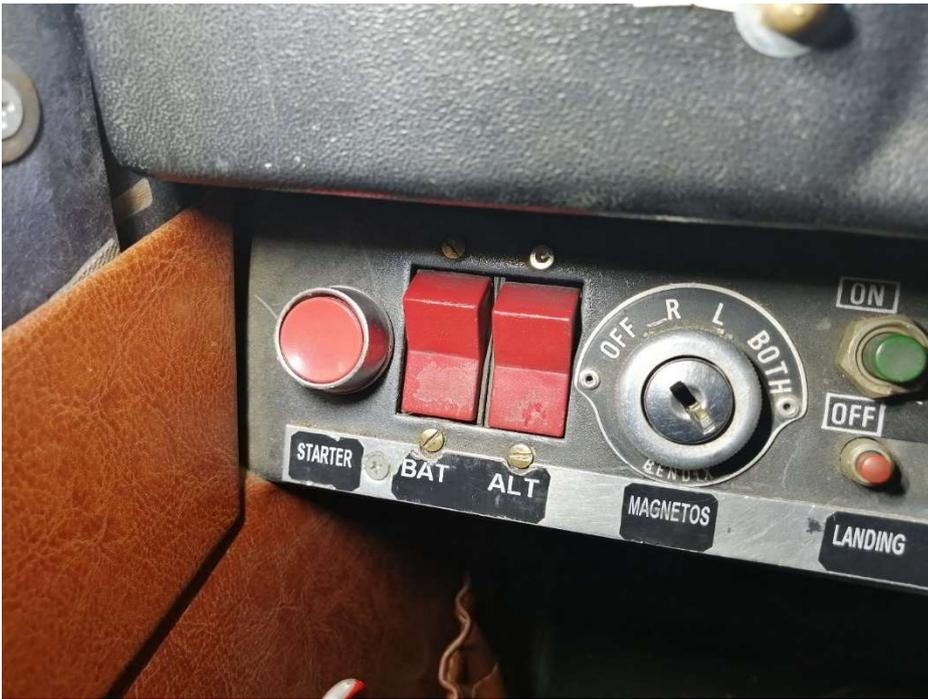
Fig. 3. BLOCCHETTO SELETTORE MAGNETI E PULSANTE AVVIAMENTO I-BOLK
