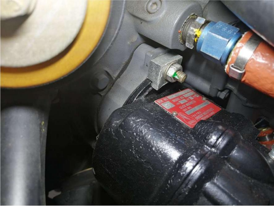
Fig. 6A; Magnete sinistro di ACMM con "impulse coupling". Notare lo spessore molto alto tra magnete e motore
