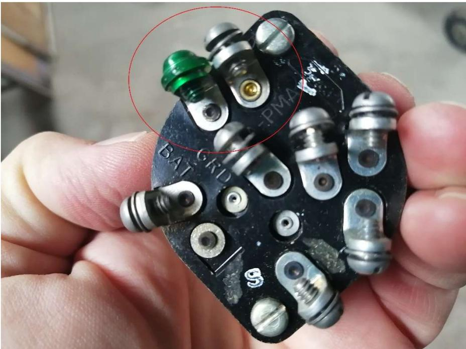
Fig.3B; Blocchetto avviamento lato contatti. Quando i due contatti evidenziati vengono collegati tra loro , con la chiave in posizione "start", il magnete destro è a massa prendendola dal contatto "GRD"
