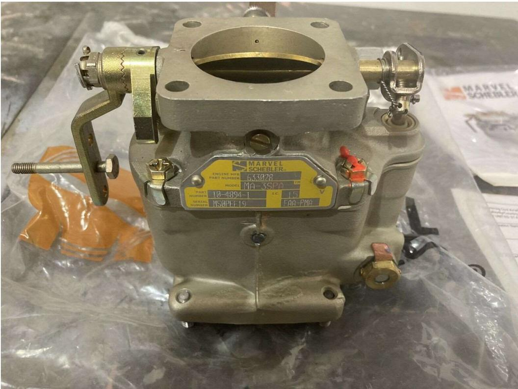
FIG 9; Carburatore MS MA3-SPA del C150 D-EFJE. Notare la pompa di recupero esterna a destra, collegata con l'albero della valvola a farfalla
