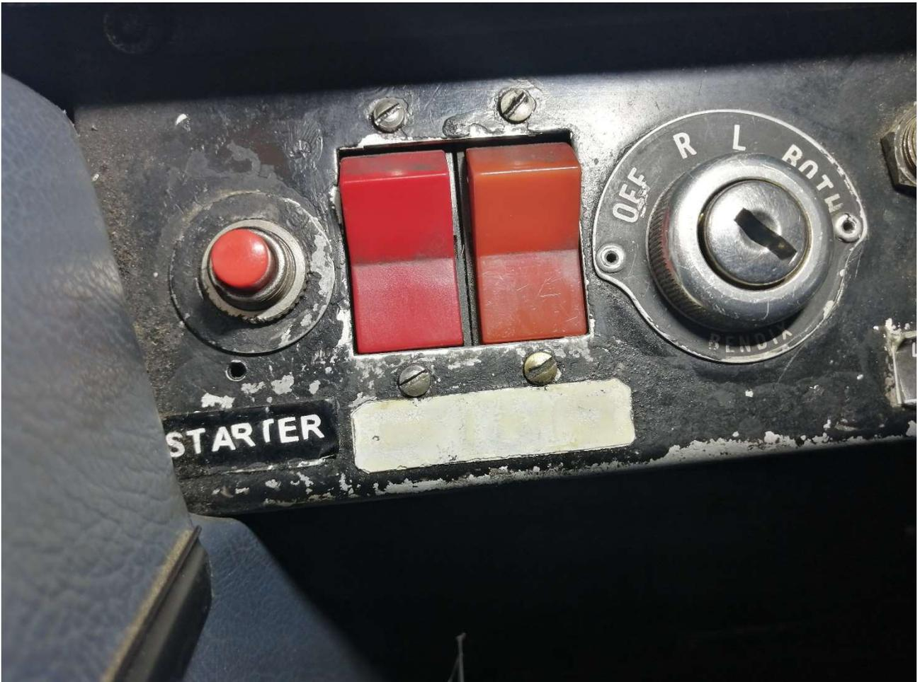
Fig.4; BLOCCHETTO SELETTORE MAGNETI E PULSANTE AVVIAMENTO I-ITAW, notare che sul blocchetto è assente la scritta "START"
